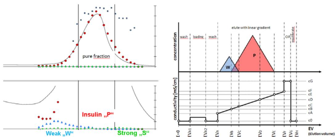
由图可知,在胰岛素精纯阶段,降解物较多,但聚集体几乎没有,要保证产品纯度,应将重点放在去除降解物 (Weak, „W“ )。
