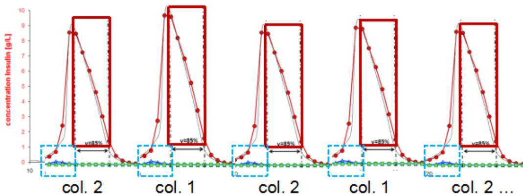
通过 MCSGP 的子模块 M-Control，可有效克服由于温度、柱效等因素造成的出峰时间迁移，实现智能收集，保证各 cycle 的工艺可控性和可重复性。
