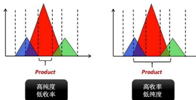
Contichrom 层析系统所特有的 MCSGP 功能（Multicolumn Countercurrent Solvent Gradient Purification），可将目标产物与杂质的重叠部分回收，进行循环式的层析操作，从而最大限度地提纯产品，使得纯度和收率二者兼得。运行 MCSGP 功能时，各 cycle 仅将最纯组分收作目标产物，从而保证了高纯度；各 cycle 均将重叠部分进行回收再上样，从而保证了高收率。
